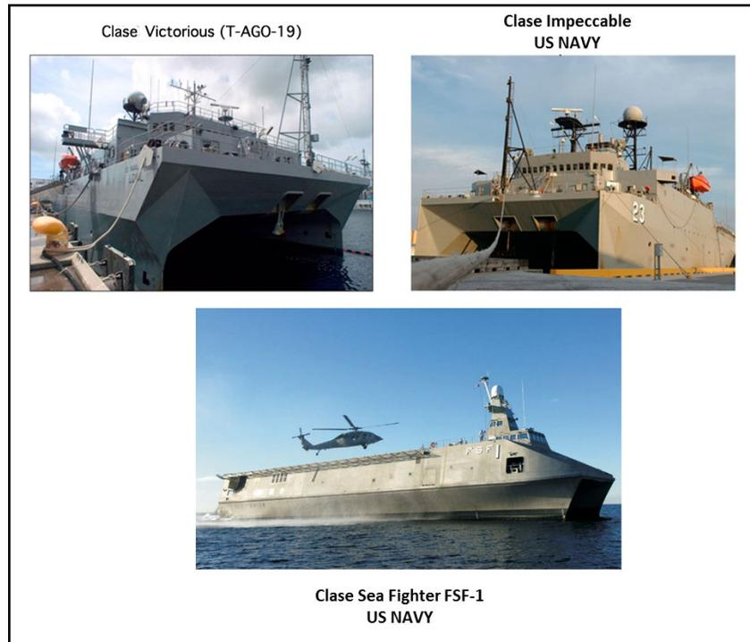
Figura 8.- Buques tipo SWATH de diferentes Armadas. Fuente: Naval today.
