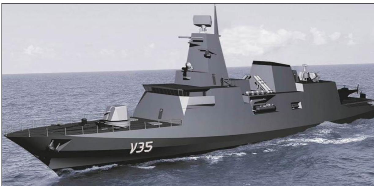
Figura 11. Diseño conceptual de la corbeta Clase Tamandaré, buque multipropósito con sensores y sistemas de armas para misiones de seguridad marítima y defensa. La Clase Tamandaré es la base del Programa de Adquisición de Medios de Superficie de la Marina de Brasil. Fuente: Marina de Brasil.
