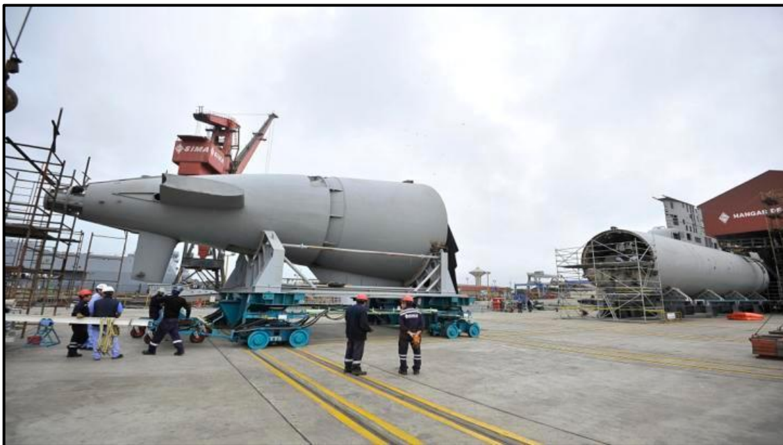
Figura 2: BAP “Chipana” cortado en dos en el astillero del SIMA, donde será modernizado.
