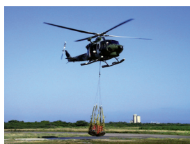
Helicóptero Bell 412-EP en operación de traslado de carga vertical
