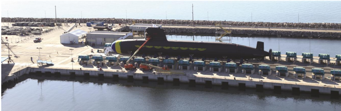
Submarino "Riachuelo" sobre el Shiplift (ascensor de barcos)
