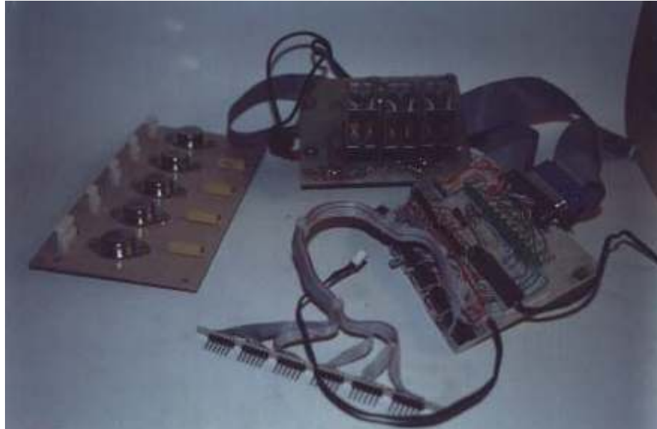
FOTOGRAFÍA 4. INTERFASE DE CONTROL AVR EN SU PRIMERA ETAPA CON TARJETA PARA CONTROLAR seis MOTORES A PASOS
