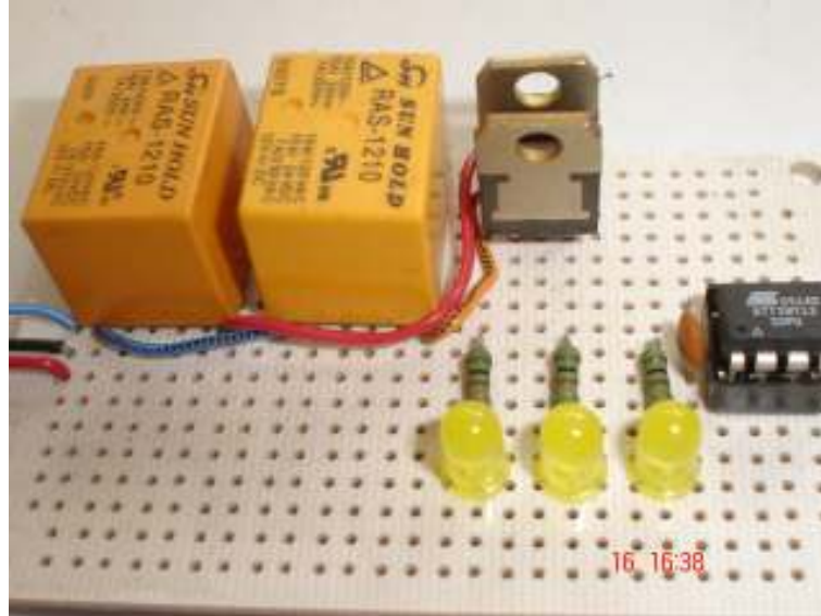
FOTOGRAFÍA 3. ATtiny12 CON ETAPA DE SALIDA POR TRANSISTOR TIP31C
