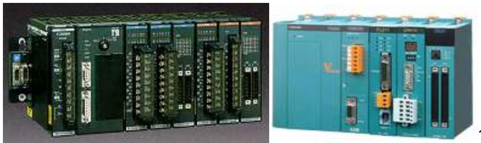
FOTOGRAFÍA 1. PLC MODULAR TOSHIBA
